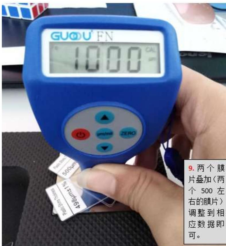
9.两个膜片叠加（两个 500 左右的膜片）调整到相应数据即可。
